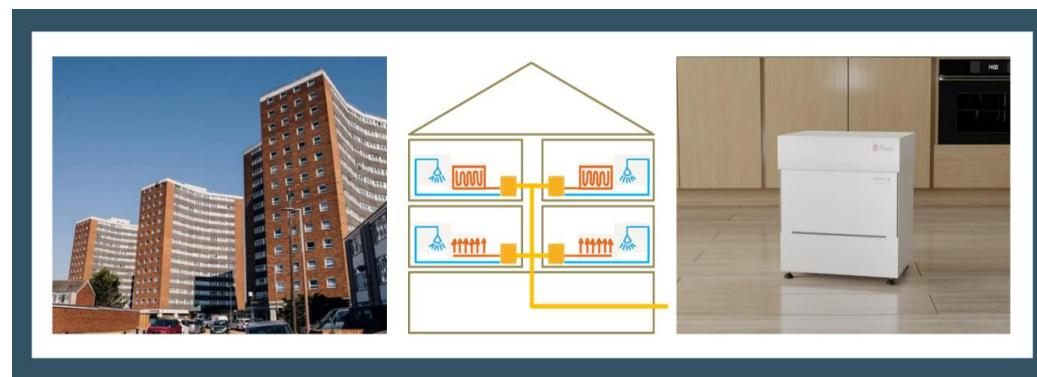
In drei Hochhaustürmen mit 273 Wohnungen wird ein vollständig dezentrales System mit gemeinsamer Wärmequelle realisiert.<sup>10</sup> Jede Wohnung erhält eine eigene kompakte Erdwärmepumpe (3-6 kW), die an ein gemeinsames Erdsondenfeld angeschlossen ist. Die Erdsonden übertragen
